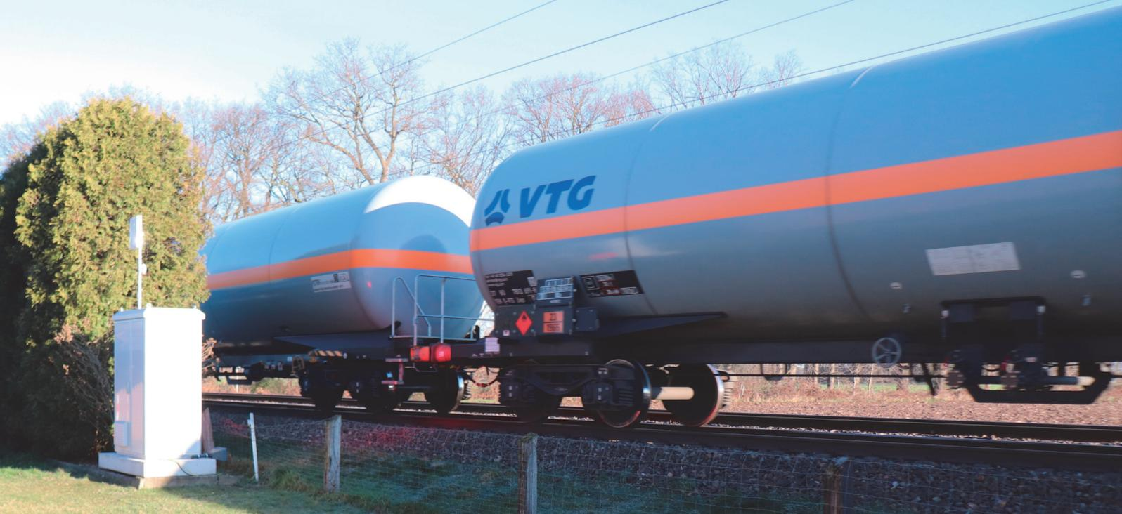
Die unauffälligen Messtationen der RailWatch erfassen Kesselwagen kontaktlos bei der Durchfahrt.
